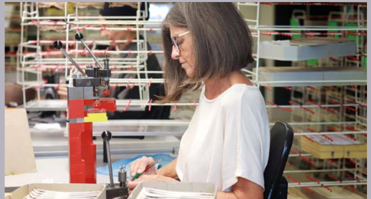
In der Endmontage ist Fingerspitzengefühl gefragt: Die Arbeiter:innen verwenden Pinzetten, um selbst kleinste Brillenteile zusammenzusetzen.
