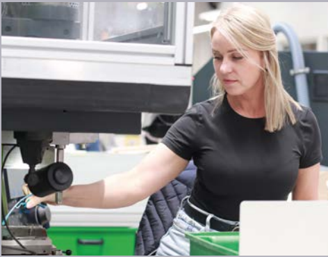
Viele Brillenteile werden im Spritzgussverfahren hergestellt. Verschiedene Kunststoffe werden – meistens auch in Kombination – verarbeitet.
