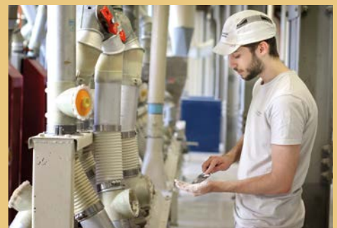
In der Kopperei wird das Getreide gereinigt, danach wird es grob geschrotet. In Sichtern werden die Bestandteile getrennt und in verschiedenen Passagen zu den jeweiligen Produkten weiterverarbeitet. Philip, der Experte aus der Kopperei, überprüft in einer visuellen Schnellkontrolle, ob Schalentteile enthalten sind.
