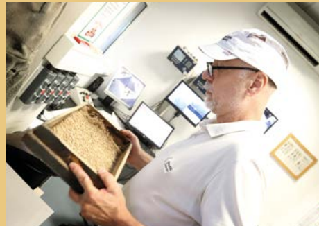
Walter arbeitet bei der Anlieferung. Er entnimmt von jeder Ladung eine Stichprobe, macht eine erste Sicht- und Sinneskontrolle und ermittelt mit einem Messgerät die Qualität und damit den Wert des Getreides. Eine weitere Probe geht ins Labor, um sie auf Pilzbefall oder Lagerschäden zu testen.
